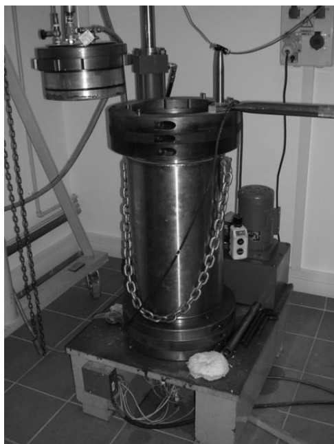
3.1. ábra Infiltráló kemence
