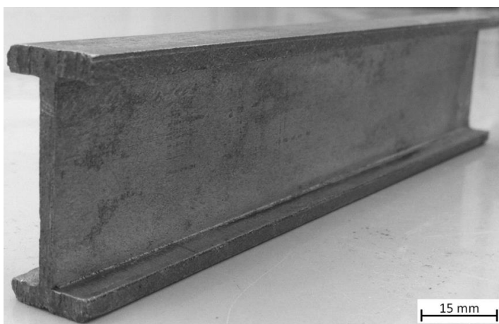
5.44. ábra Kompozithuzalokkal erősített szintaktikus fémhab I-tartó fényképe
