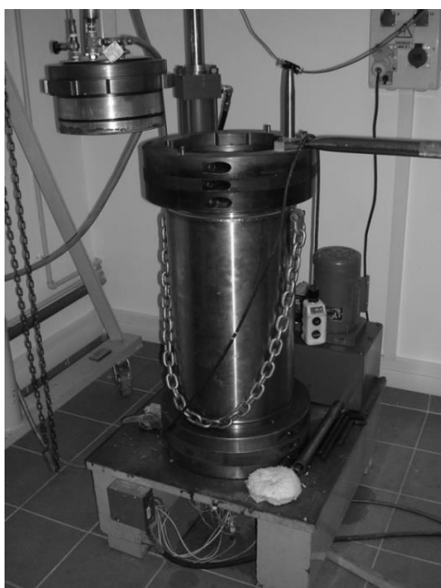
3.1. ábra Infiltráló kemence
