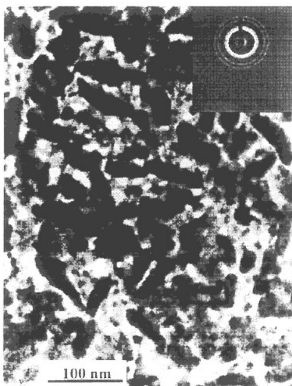
73. ábra: Az arany nanorészecskék transzmissziós elektronmikroszkópos képe 30 perces \text{Ar}^+ ionporlasztást követően. Az elektrondiffrakció szerint a részecskék csak aranyat tartalmaznak.
