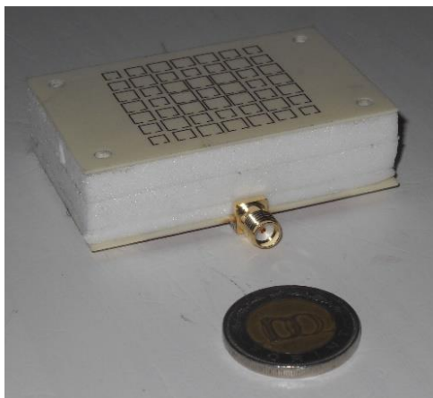
B_A13. Metaanyag lencsével szerelt foltantenna prototípusa.
