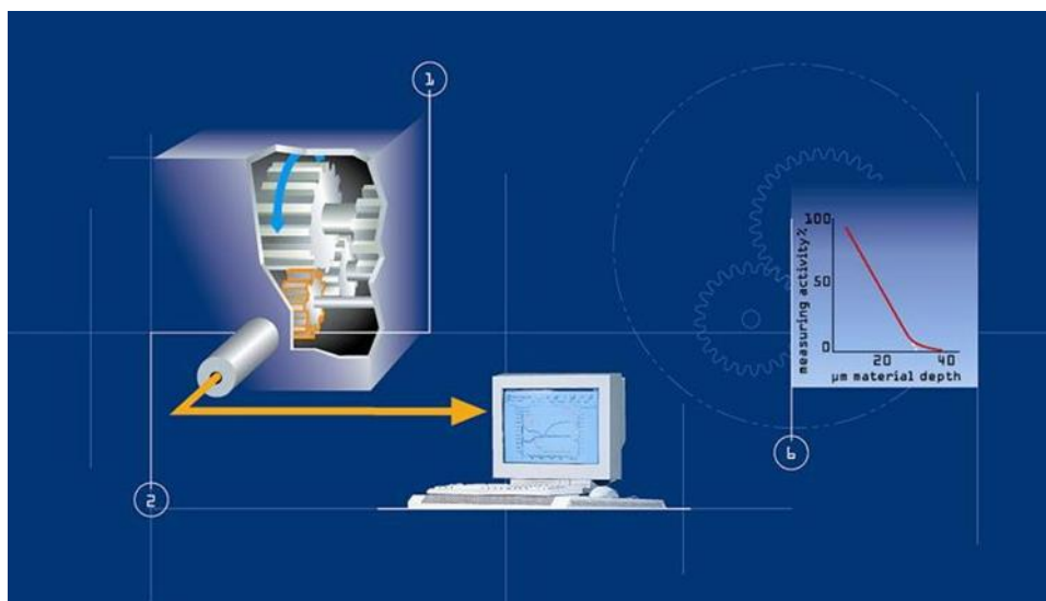
18. ábra A direkt mérési módszer sematikus diagramja [48]
