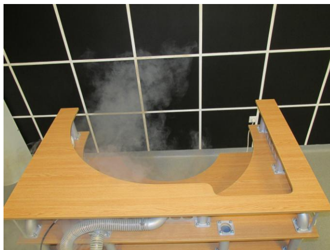
5.2 ábra Befűvőelemek füstöléses tesztelése
