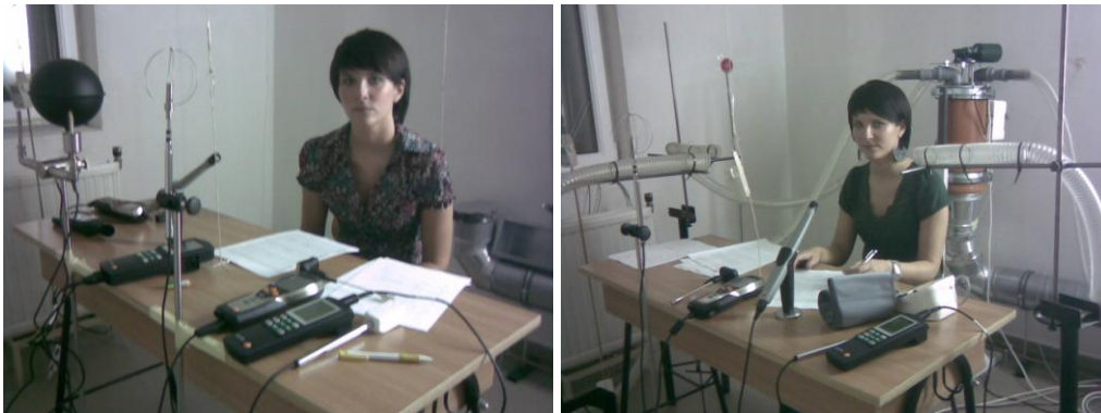
4.14 ábra Mérések F-F és F-L LVR rendszer (bal oldali kép) és személyi szellőző rendszer (jobb oldali kép) esetében
