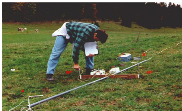
I.2 ábra: Az első, null-elrendezésekkel végrehajtott mérések esetén még kényszerítően ügyeltünk az elektródák pontos pozicionálására. Az elektródák a műanyag cső, illetve a rá rögzített faléc végeinél vannak.
