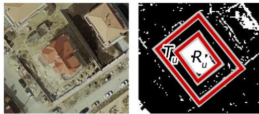
8. ábra egyszerű színszűrővel működő tetőszegmentáció, majd a szegmentált kép alapján felírható objektum-energiát meghatározó R_u és T_u képrégiók
