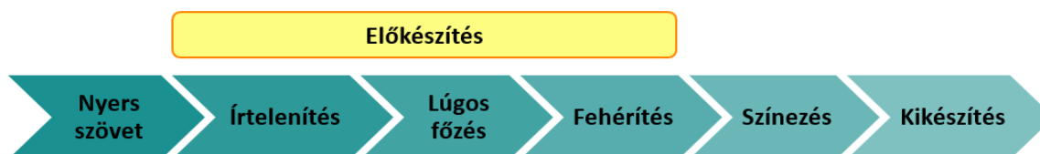
10. ábra. A cellulóz alapú kelmék hagyományos nedves textilkikészítési technológiájának a legfontosabb részfolyamatai
