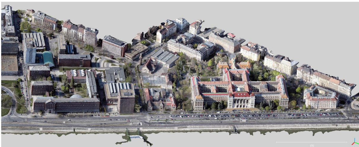
2. ábra: Pilóta nélküli repülőgépes rendszerrel (UAS) végzett felmérésből származó textúrázott felszínmodell a BME történelmi kampuszáról
