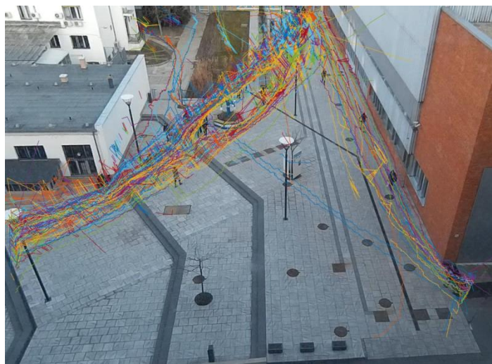
b) gyalogos-trajektóriák előállítása az összetartozó azonosítók súlypontjainak egyesítésével
