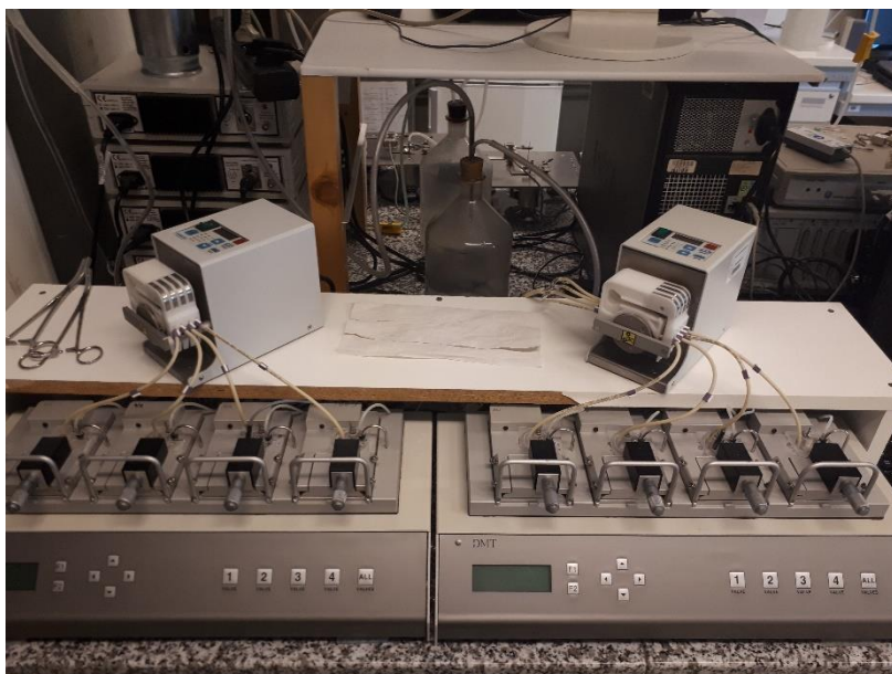
2. ábra: Mayo Myograph, 8 káddal és 8 csatornás adatrögzítő rendszerrel
