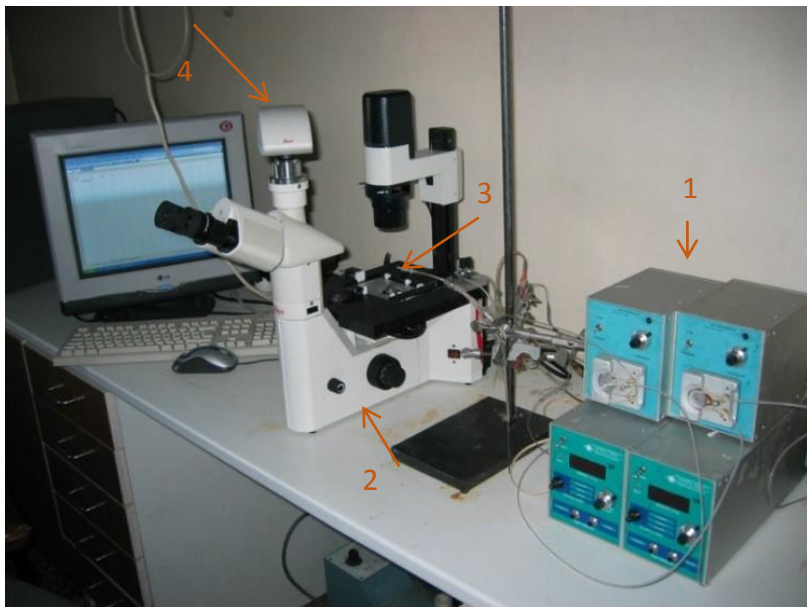
1. ábra: In vitro mikroangiometriás mérőrendszer. 1. Szervopumpa 2. Inverz mikroszkóp 3. Szervfürdő (egy izolált ér vizsgálatára alkalmas) 4. Mikroszkópos kamera
