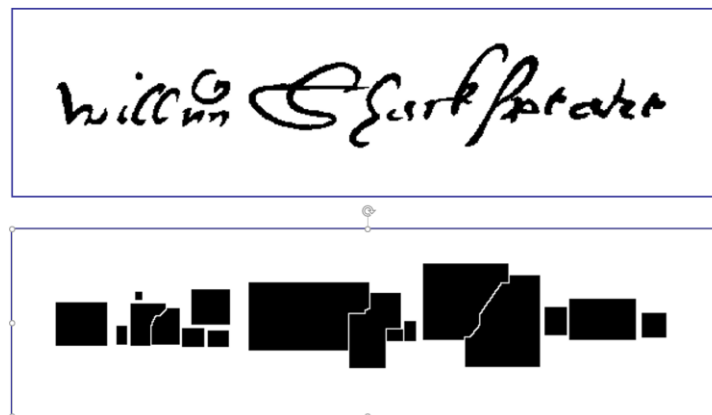
8. ábra. Shakespeare aláírásának üregfeltöltése. Kameswara Rao és munkatársai iteratív párhuzamos algoritmusának kitöltő illesztőmintái az üregpontok feketévé változtatása mellett az objektumokat az álló befoglaló téglalapjukra húzzák ki. Amennyiben a befoglaló téglalapok átfedik egymást, úgy marad közöttük egy egypixeles „szigetelő” réteg.
