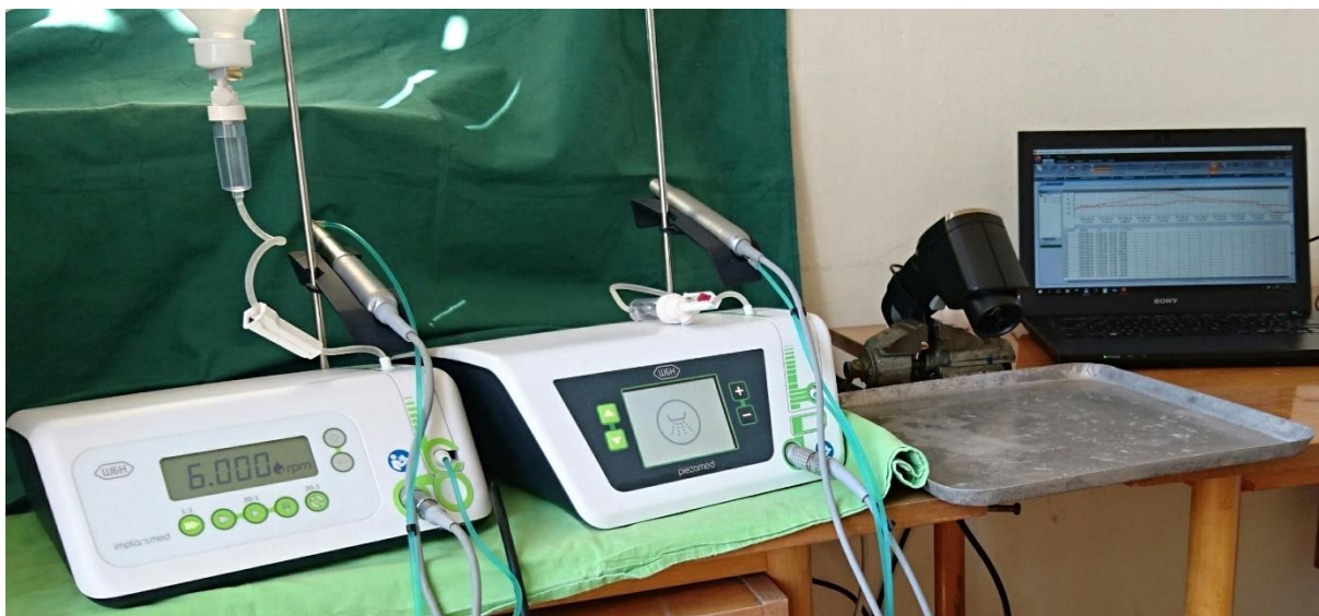
32. ábra: A vizsgálati munkaállomás. Balra a fiziodiszipenzer, mellette a piezoelektromos egység, tőle jobbra a hőmérő optikai egysége és a kép szélén jobbra a rögzítésért és irányításért felelős laptop.
