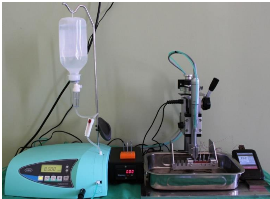
24. ábra: A fűrótorny együttműködése a sebészi fiziodiszipenzerrel, egyenesdarabbal, időmérő egységgel és hőmérő egységgel.
