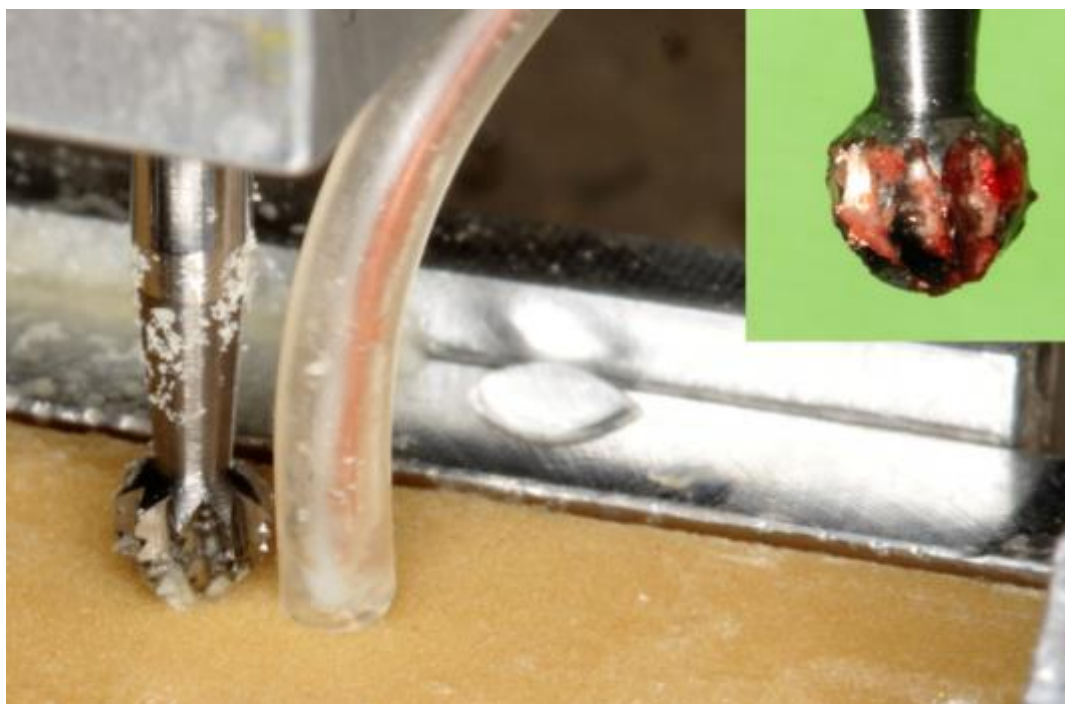
77. ábra: A poliuretán blokkok fúrásakor teljesen más forgács (inkább por) keletkezik, és a vágóélek közötti terek eltömődése is teljesen más, mint a humán csont fúrásakor (lásd jobb fent, kis képben).
