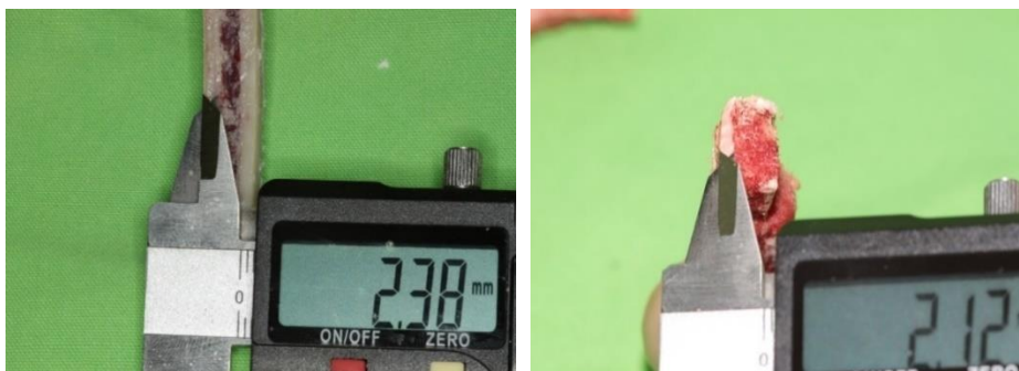
28. ábra: A bordák kortikálisának mérései digitális tolómérővel. Balra marhaborda, jobbra sertésborda.
