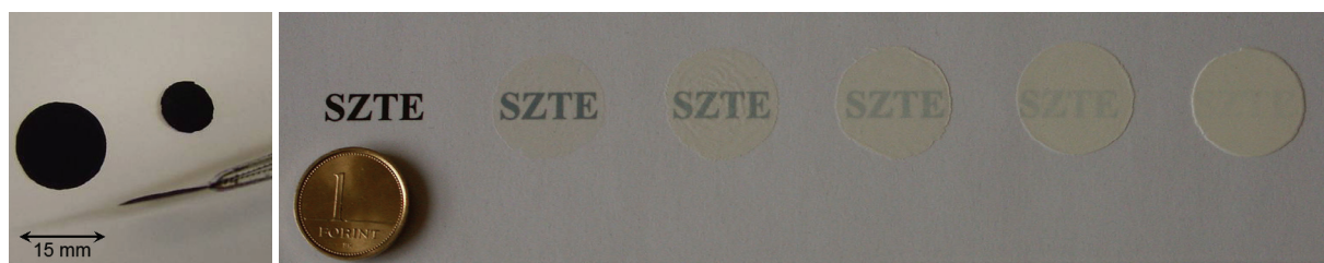
144. ábra. Szén nanocsővekből és titanát nanoszálakból készült önhordó filmek
