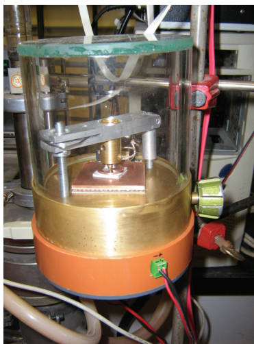
34. ábra. Az általunk kifejlesztett hővezetőképesség-mérő berendezés bemutatása
