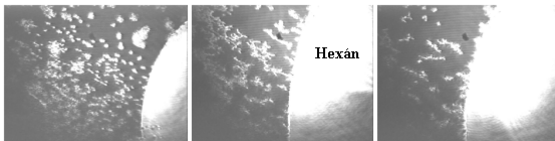
78. ábra: A vízfelszínen párologó hexán lencséből (mindig a kép jobb oldalán) kiáramló natív szilika részecskék füzerei különböző időpillanatokban (a Stöber szilika részecskék átlagmérete kb. 60 nm). A részecske füzerek jobbról balra haladnak, szinte „kibújnak” a szerves folyadék belsejéből [191].
