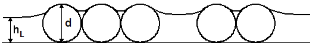
3. ábra: Ha a részecskék átmérője ( d ) nagyobb, mint a vízfilm vastagsága távol a részecskéktől ( h_L ), a vízfelszín torzul, ami a részecskék közti kapilláris vonzóerők ébredését eredményezi [35].
