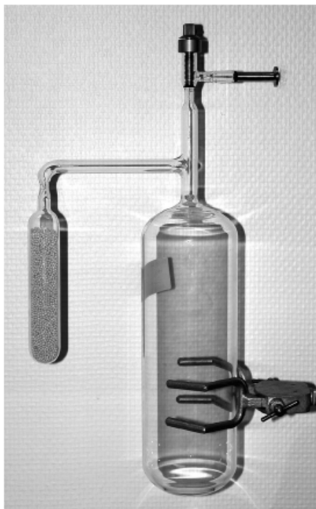
10. ábra: Izotópdúsított gázok tárolóedénye. A gáz visszanyerése az üvegbe helyezett molekuláris szűrő (nagy porozitású alumínium-szilikát) segítségével történik. Ezt, ha lehűtjük folyékony N_2 -nel, adszorpciós szivattyúként viselkedik és képes megkötni az oxidációs kamrában levő gázt. Ha felmelegszik, akkor viszont újra kibocsátja a gázt, lehetővé téve a többszöri alkalmazást. A molekuláris szűrő anyaga és a palackban levő oxigéngáz között nem találtak kicserélődést [Ams07].
