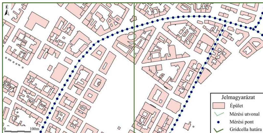
4.5.2. ábra A mérési útvonal és a mérési pontok elhelyezkedése Szeged két központi fekvésű cellájában
