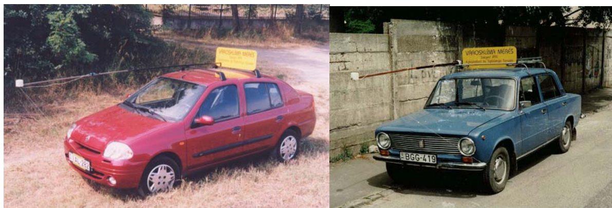
3.2.2. ábra A mérőautók a rúdra felszerelt hőmérsékleti szenzorral
