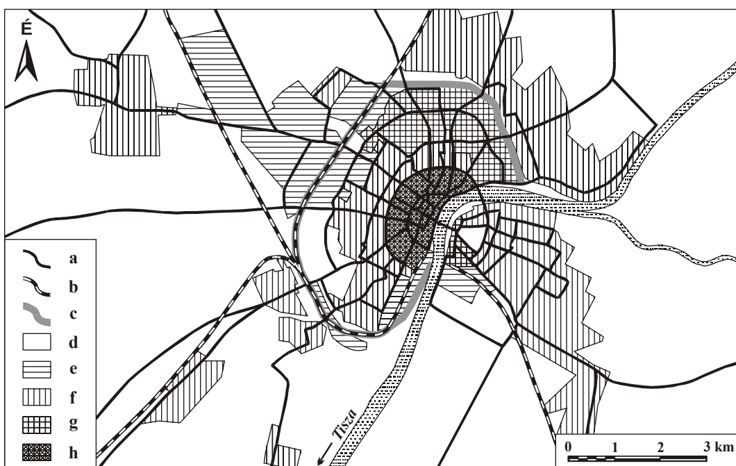
3.1.1. ábra Az (a) úthálózat, (b) vasútvonalak, (c) körtöltés és a fő beépítettségi típusok Szegeden: (d) mezőgazdasági és szabad terület, (e) ipari és raktározási terület, (f) családi házak, (g) panel lakótelepek, (h) belváros, 2-4 emeletes épületekkel
