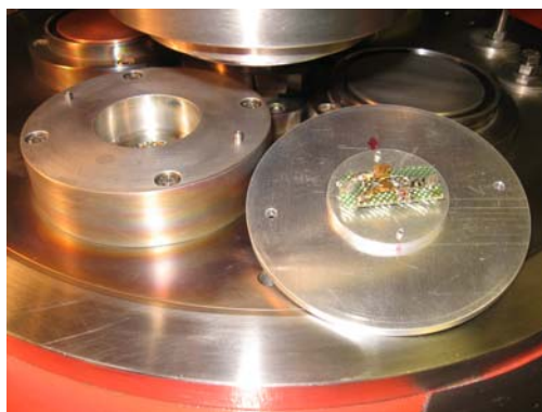
1.4. ábra. Mintabefogó TO 9 tokozású lézerciódák számára.
