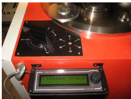
1.5. ábra. A target-tartó karusszal időzített forgatására szolgáló programozható berendezés és a recipiens alatt elhelyezett léptetőmotoros forgatómechanizmus.
