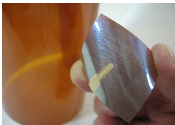
4.7. ábra. a-SiGe-vel bevont üvegszál-erősítésű műanyag lapka.
