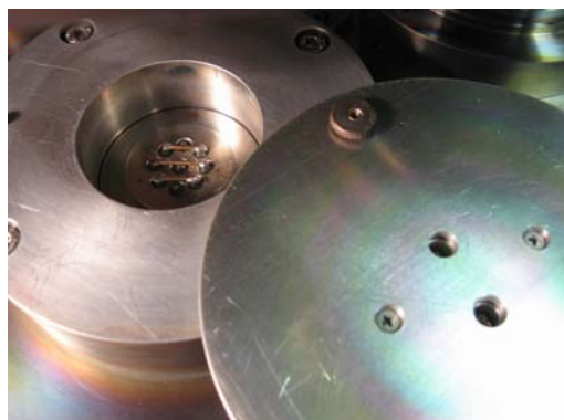
1.4. ábra. Mintabefogó TO 9 tokozású lézerciódák számára.
