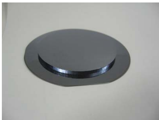
4.1. ábra. A targetként használt szilíciumszeletre rögzített SiGe egykristály fényképe.
