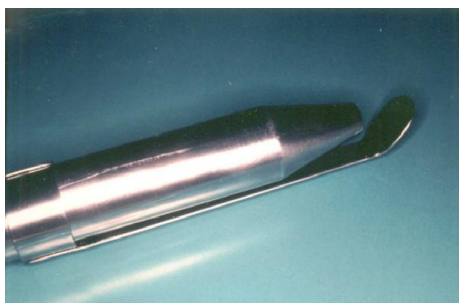
A) A normál kézidarab helyére csatlakoztatható eszköz, mely a lézersugár haladási irányába 45^\circ szögben elhelyezett fix fémtükör segítségével a sugarat reflektálja. A kézidarab megfelelő szögben való beállításával a direkt rálátásból nem kezelhető területekre is eljuttatható a lézersugár.
