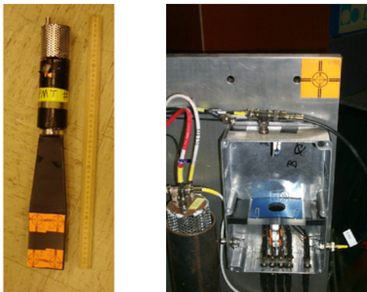
11. ábra. Bal oldal: a Spektrométer Trigger fal építéséhez használt, (alulról felfelé) szcintillátorból, fényvezetőből, PMT-ből és az azt tápláló osztóláncból álló modul. Jobb oldal: a PMT modulok erősítését és kvantumhatásfokát ellenőrző világító diódát és optikai kábeleket alkalmazó kalibrálóegység.
