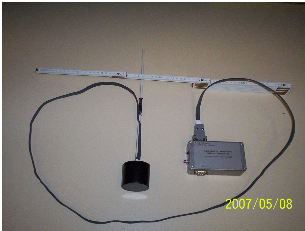
2.4.2. ábra. A kész eszköz fényképe. A térszonda vékony műanyag védőburkolatban helyezkedik el, a képen a hajlékony elvezetés közvetlenül csatlakozik az erősítőhöz.
