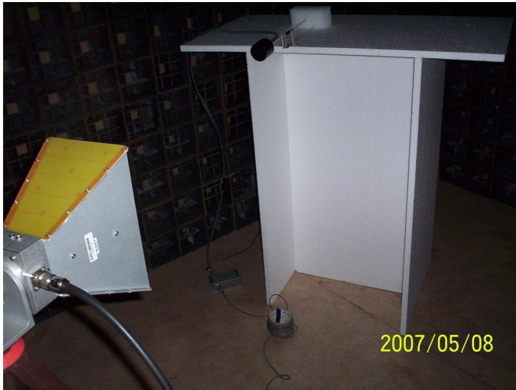
2.4.5. ábra. A detektor érzékenységének kalibrálása reflexiómentes helységben.
