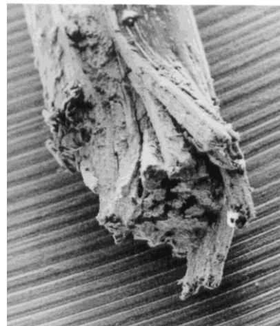
4.8 ábra (a) HGK huzal palástja az 500 ciklusos r=0.01 amplitúdójú fárasztás után. A palástot mély repedések barázdálják. (b) A fárasztási szakadás tartományában a huzal rostkötegekre bomlott (Szökefalvi-Nagy, 1984).
