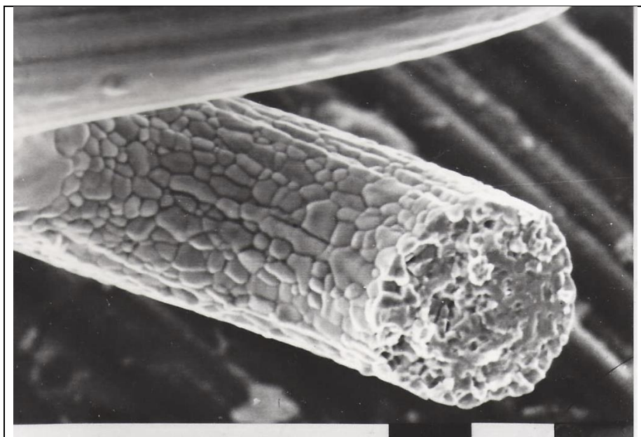
7.1. ábra. „Lokális” szövetszerkezeti hiba egy beégetett spirálban. A hibás szakasz szabad felületén és tranzverzális töretfelületén 5-6 \mu\text{m} -átmérőjű, közel ekvixiális szemcsék vannak.
