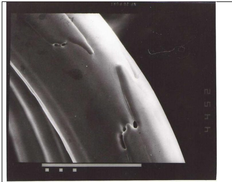
F2.2 ábra. Ez a felvétel azt mutatja, hogy az önzáró szemcsehatárokon a lámpa üzeme során 5 \mu\text{m} -es átmérőjű üregek képződnek. (A marker-jel 100 \mu\text{m} .)
