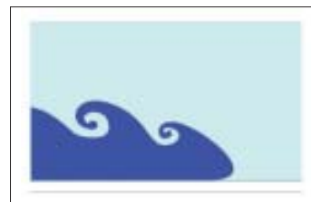
8. ábra: A haladó front felső határán a Kelvin–Helmholtz-instabilitás következtében jellegzetes fodrozódás jelenik meg
