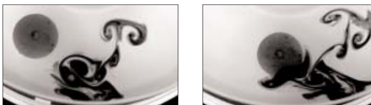
28. ábra: a) A forgatott, vízzel telt edény fenekén rögzített alacsony henger elé festéket fecskendezünk. b) A szétterjedő festék a 27. ábrának megfelelően függőleges felületek mentén oszlik szét a folyadék teljes mélységében (a felülnézeti képen ezért jelenik meg egy éles mintázat), de nem folyik rá a hengerre, hanem megkerüli a fölötte lévő vízoszlopot, a Taylor-oszlopot is
