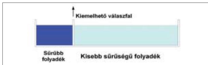
5. ábra: Átlátszó kísérleti kád kiemelhető válaszfallal, bal rekeszébe sűrűbb folyadékot töltünk
