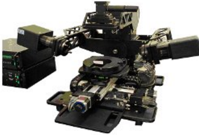
2.1. ábra. Forgó kompenzátoros spektroszkópiai ellipszométer felépítése [54].
