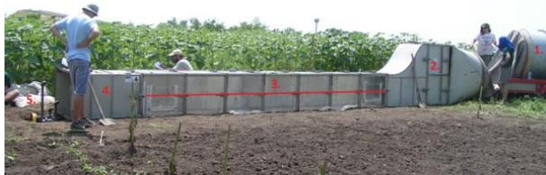
2. ábra Szélcsatorna (részei: 1. turbina, 2. laminátor, 3. szélcsatorna elemek, 4. szedimentálca, 5. szélcsatorna kimeneti nyílása, csapadázók területe)
