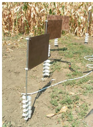
8.28. ábra. Wilson and Cooke csapda (Goossens et al. 2000) csapdatest (baloldal) és az apátfalvi területre kitelepített csapdázók (jobb oldal)
