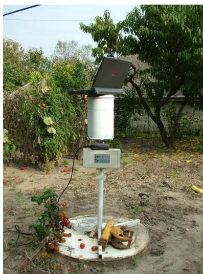
6.2. ábra A BCU Lite 2 csapadékmérő berendezés a helyszínen (Pázmánd)
