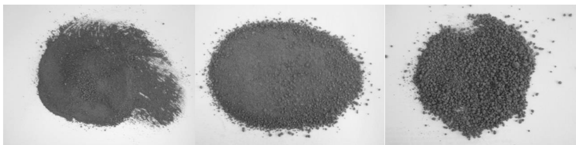
8.11. ábra Az egyes csapdázódási helyeken felhalmozódott talajanyag szerkezetessége. (Balra: II. fogó mintája (10–40cm); középen: I. fogó mintája (0–10cm); jobbra: láda után gyűjtött minta)
