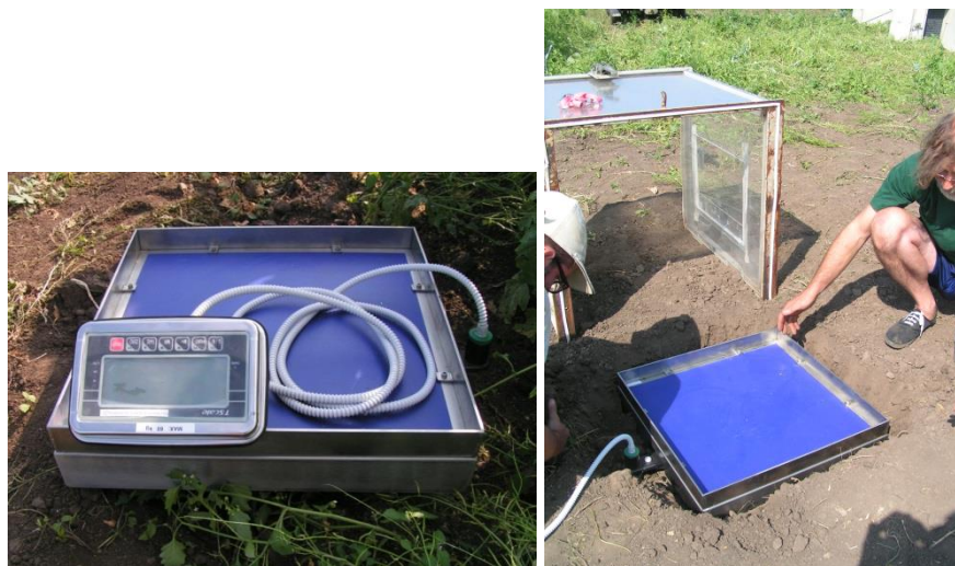
6.16. ábra BWS-60 típusú elektronikus platform mérleg, és elhelyezése
