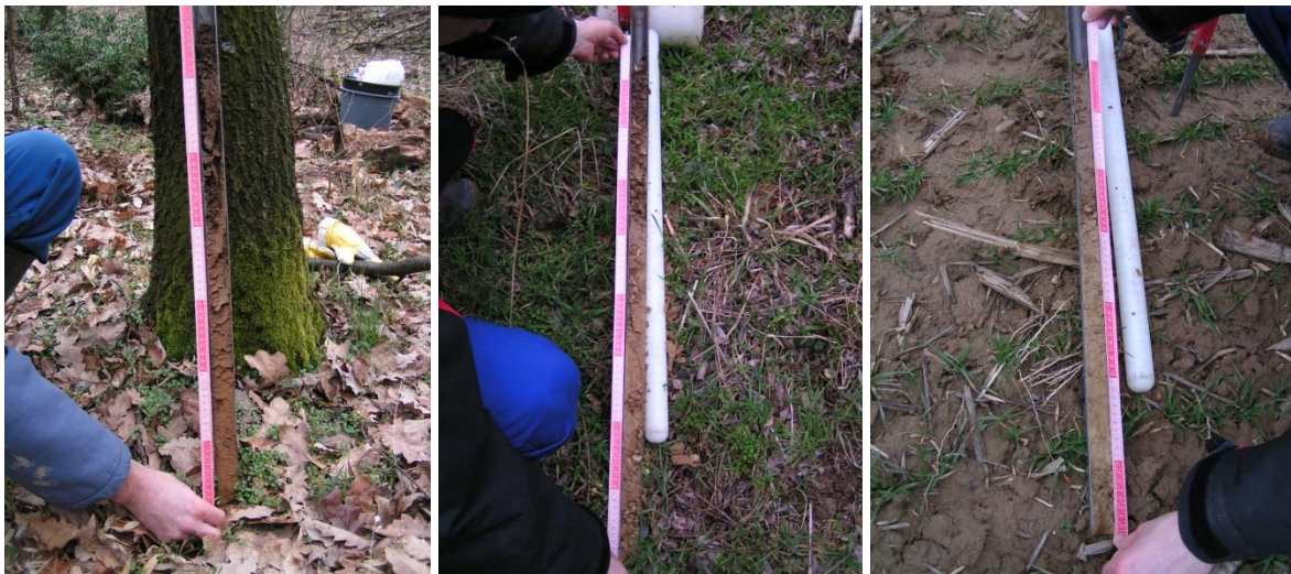
6.3. ábra Szelvényleírás és humuszréteg vastagság megállapítása Pürkhauer-féle szűrőbottal
