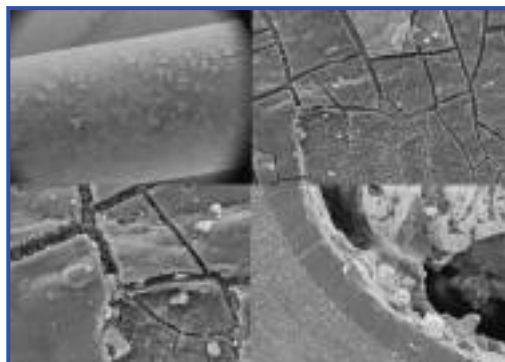
30. ábra: 6 hetes sztent viselést követően kialakult inkrusztáció a sztent különböző területén, különböző metszetekben
