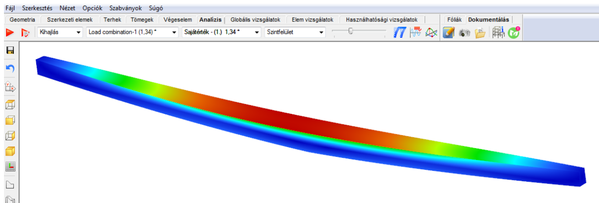
F.7.7. ábra. A szerkezeti modell kifordulása a héj végeselemes mechanikai modell alapján ( \alpha_{cr}=1.34 ).
