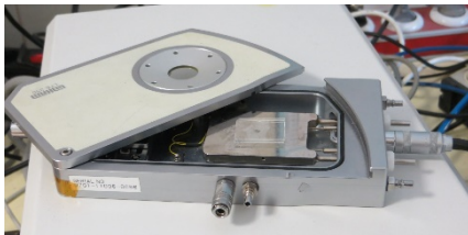
A Linkam LTS350 fűthető tárgyasztala, és a saját készítésű Peltier-elemes mintatartó
