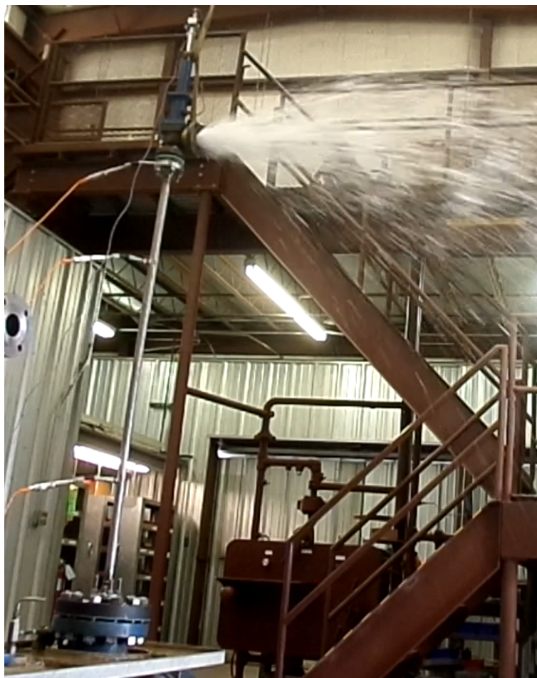
55. ábra. 2J3 szelep 3 m felvízoldali csővel, működés közben.
