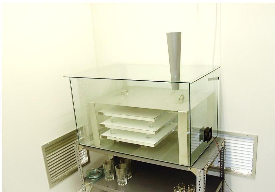
4.5 ábra Mérőállás a belsőépítészeti anyagok szennyezőanyag emissziójának meghatározásához [134]
