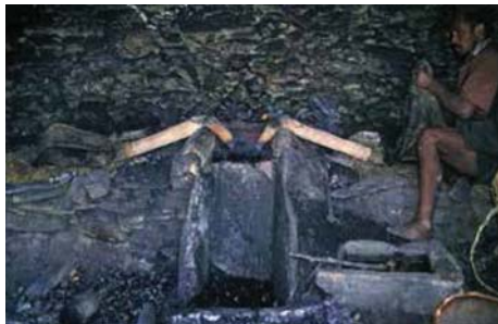
20. kép: Rögzített öntőtégely alkalmazása Nepálban, a 20. században (STÖLLNER et al. 2016. Fig. 6. nyomán)
