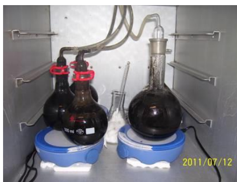
6.kép. Szennyvíziszap-rothasztó modellrendszer Fotó: Wirth Balázs (Iszaprothasztókként gömbölyű lombikokat használtunk, melyekből szilikoncsöveken keresztül elvezettük a keletkező biogázt a gázméréshez. A lombikokat termosztátban mágneses keverőasztalokra helyeztük, és a kísérlet során folyamatosan kevertettük az iszapot)
