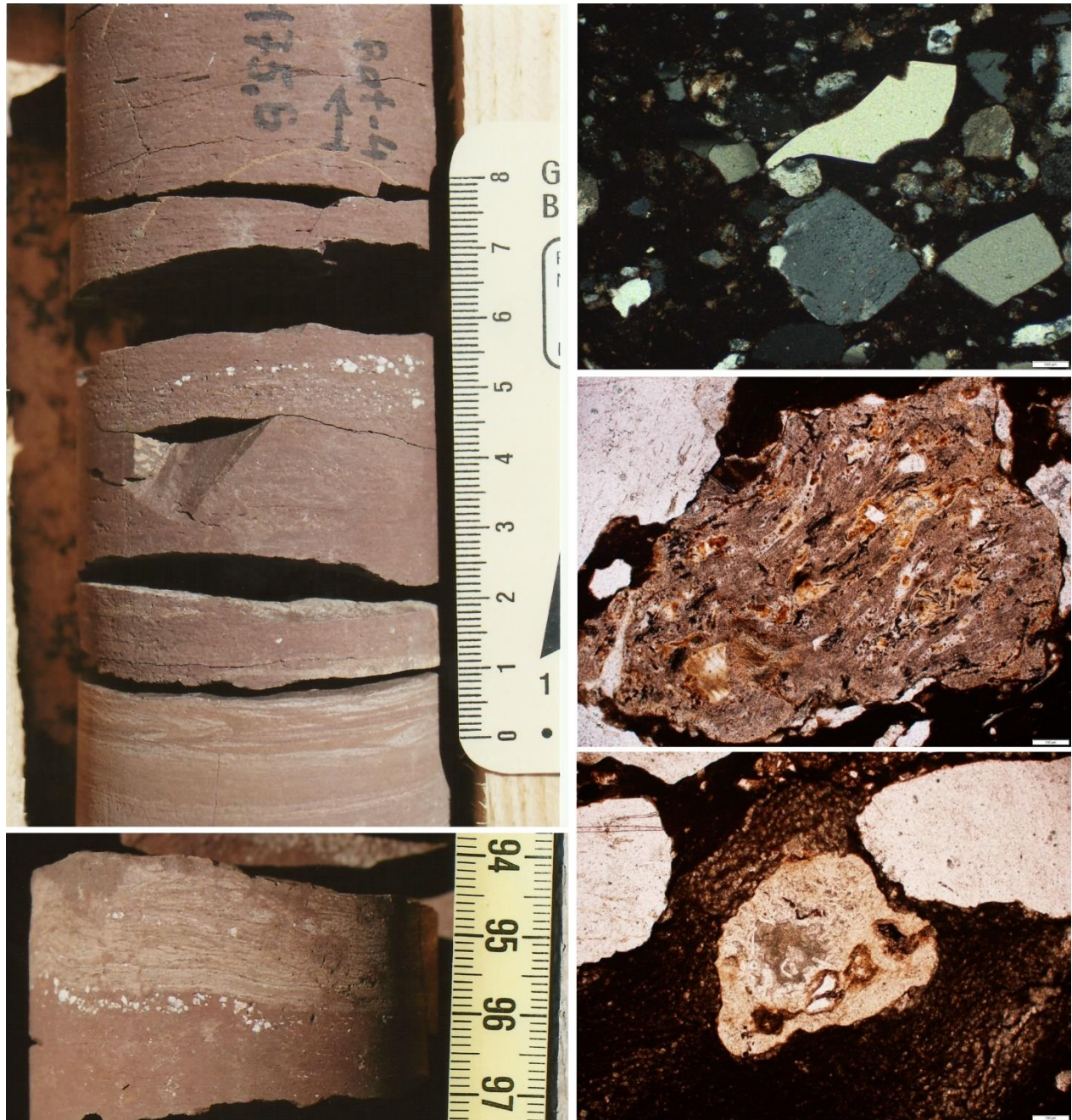
Homokméretű szemcséket tartalmazó betelepülések a Bodai Agyagkő Formáció agyagkő kifejlődésében (BAT-4/2 fúrás, balra fent: 1175,7 m; balra lent: 906,45 m). A szemcsék között jelentős mennyiségű a szilánkos kvarctöredék (jobbra fent), valamint a horzsakő és vulkáni kőzettörmelék eredetű fragmentum (jobbra középen és lent); a kőzetmikroszkópi fotókon a lépték 100 \mu m
