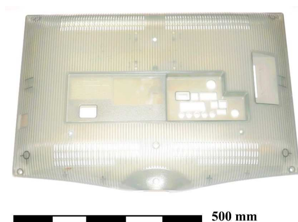
XII/7. ábra Reciklált PET-ből fröccsöntött, égésgátolt televízió hátlap
