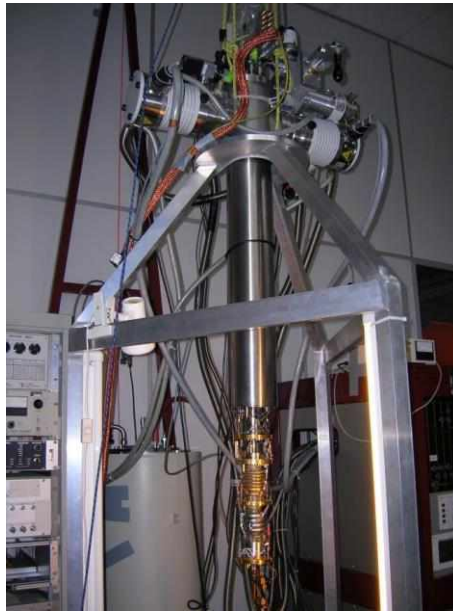
2.1. ábra. CRESST projekt, Max Planck Institut München. ^3\text{He}/^4\text{He} kriosztát, nyitott állapotban, melyet a detektor-rétegek teszteléséhez használtunk. Alaphőmérséklete: 8 mK.
