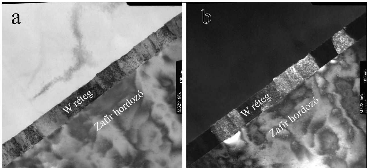
2.8. ábra. \text{Al}_2\text{O}_3 hordozón \text{CO}_2 beeresztés mellett növesztett W-réteg azonos területének (a) világos- és (b) sötétlátóterű keresztmetszeti TEM felvétele. A zafír tetején jól látható a különböző orientációjú kb 200 nm méretű szemcsékből álló, polikristályos W réteg.
