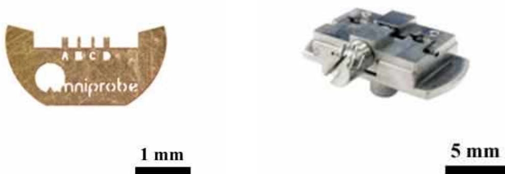
1.8. ábra. (a) FIB-TEM mikrostély és (b) a korábban alkalmazott, kereskedelemben kapható - bonyolult konstrukciójú, miniatűr satuszerű - mikrostély befogó.
