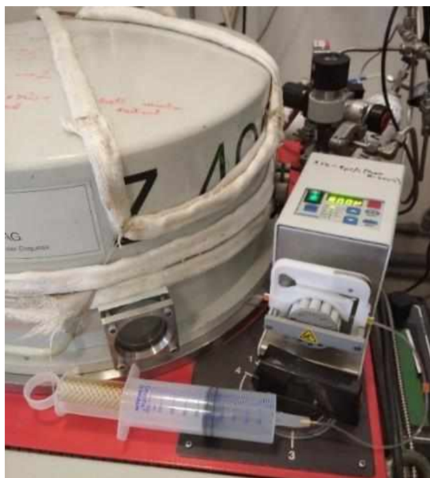
3.24. ábra. A kombinatorikus minta reaktív RF porlasztásánál használt berendezés fényképén balra a porlasztókamra, jobbra az önszabályozó gázbeeresztő rendszer perisztaltikus szivattyúja és előtérben az O 2 gázt tartalmazó fecskendő látható.
