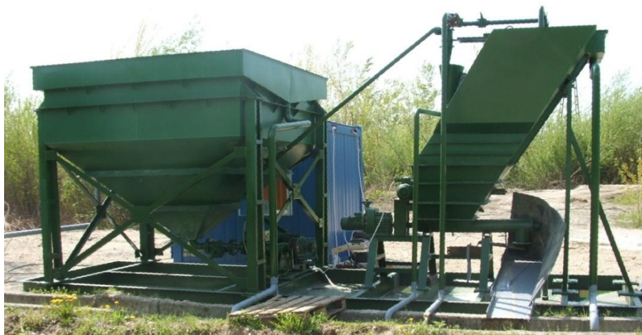
3.1.18. ábra. Az üzembe helyezett osztályozó és zagysűrítő technológia a kezelői konténerrel
