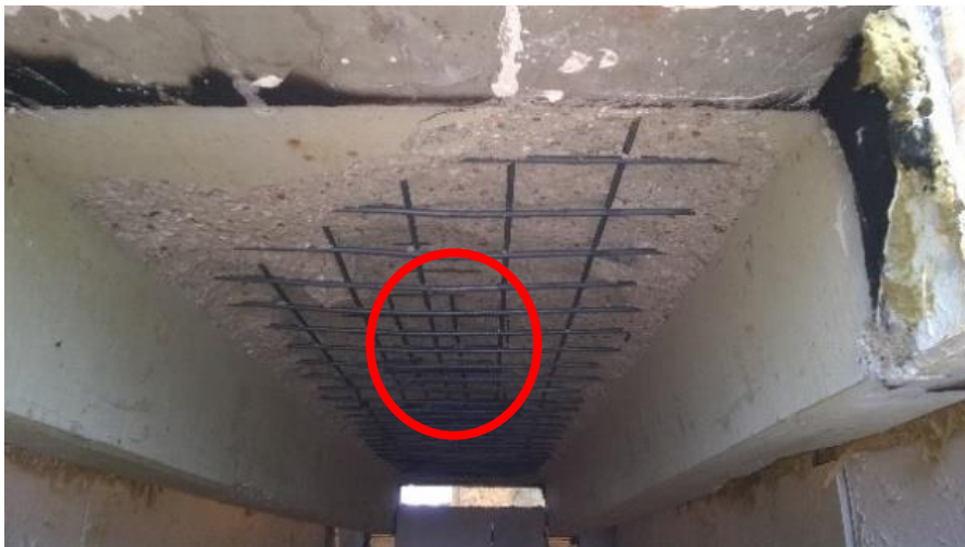
2 ábra: Az etalon betonú TT panel a vizsgálat után
