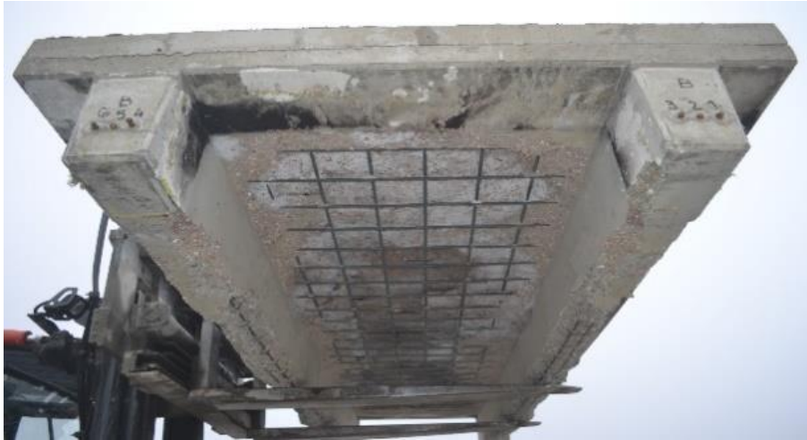
3. ábra: A módosított betonú TT panel a vizsgálat után
