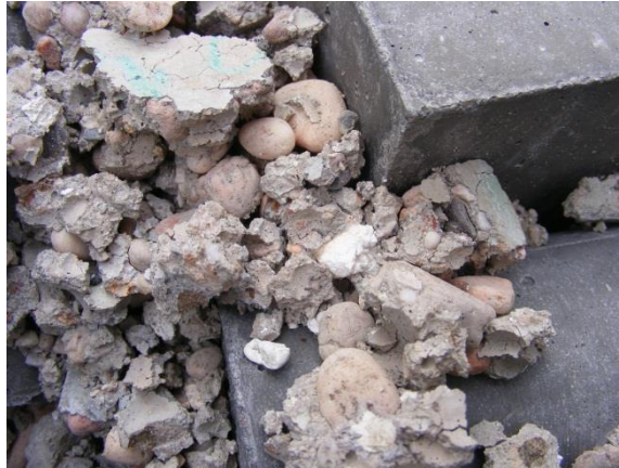
4. ábra: A felrobbant próbatestek (saját felvétel)
