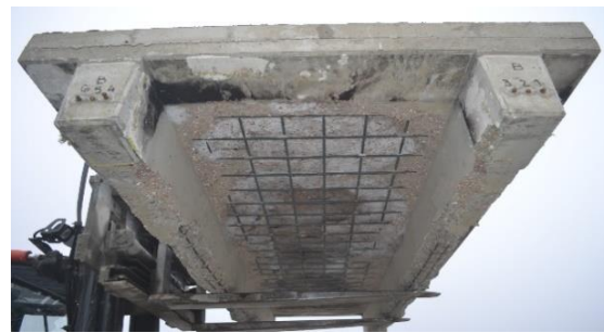
d) a módosított betonú TT panel a vizsgálat után
