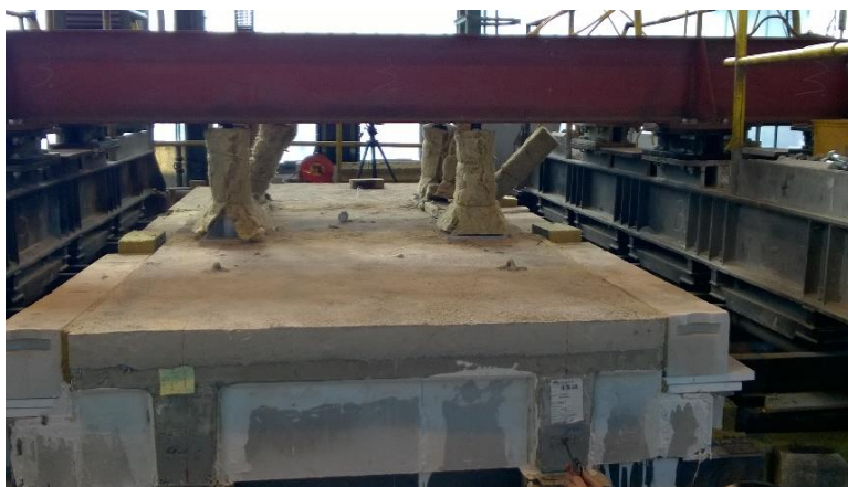
4.4. ábra: A beépített födémelem, TT panel (fotó Lublőy, 2019)
