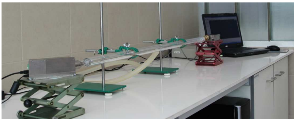
3.4.2. ábra. Kísérleti összeállítás a MINI-X-Ag röntgenső emissziós spektruma méréséhez.
