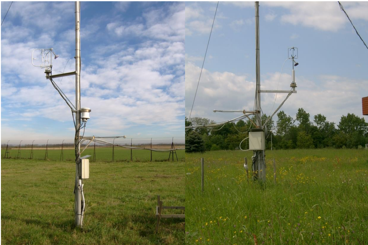
3.1. ábra. A HU-He2 EK állomás fényképeken. Bal oldal: az 1999-2000-ben üzemelő rendszer az eredeti Kaijo-Denki anemométerrel. Jobb oldal: a rendszer immár a GILL R3-50 anemométerrel, ami 2006 októberétől üzemelt. Látható, hogy a beszívócső helyzete változott a műszercsere után. A két fotó más szemszögből készült (a szónikus anemométert tartó árbóc északi tájolású). A LI-6262 analizátort tartalmazó műszerház nem látható a fotókon.
