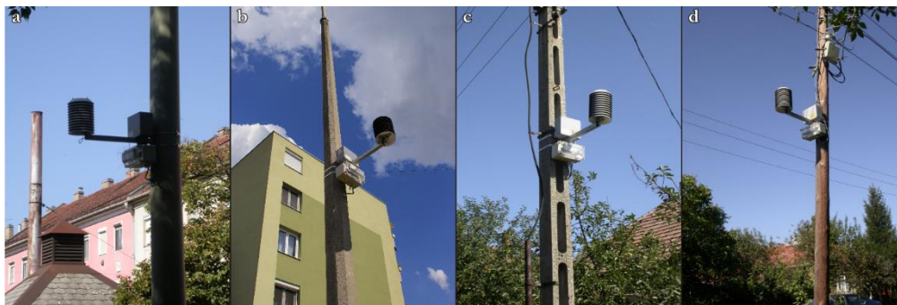
5.20. ábra A mérőállomások elhelyezése (a) acél és (b) beton kandeláberen, illetve (c) beton és (d) fa villanyoszlopon (Unger, Gál 2017)
