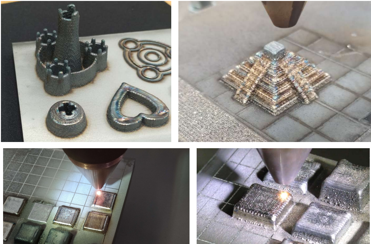
4.2. ábra A 3D fémnyomtatóval előállított mintadarabok.
