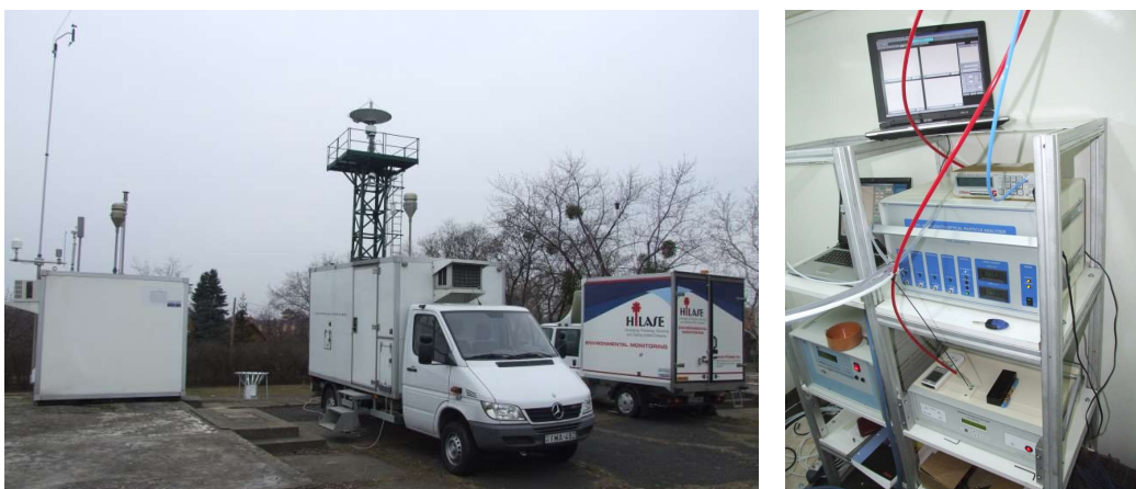
2.16. ábra A baloldali kép jobb oldalán látható a klímakontrollált mobil mérőállomás az Országos Meteorológiai Szolgálat Gilice téri telephelyén, valamint a beépített műszereink a jobboldali képen.
