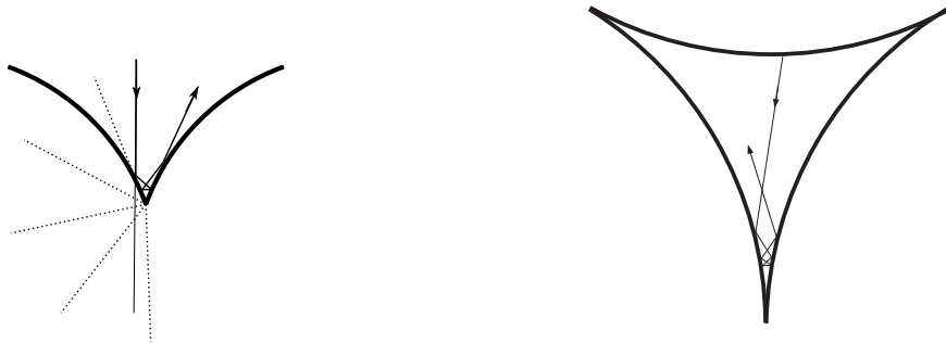
(a) (Transzverzális) sarokpont esetén az iterációk száma korlátos. (b) Érintő sarokpont esetén az iterációk száma nem korlátos
