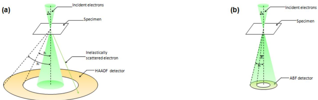
2. ábra. A HAADF (a) és az LAABF (képen ABF) (b) detektorok sugármenetének összehasonlítása. Az eredeti kép a https://www.jeol.com/words/emterms/20121023.015059.php#gsc.tab=0 oldalon található.
