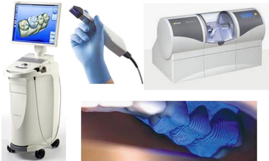
7. ábra A CEREC Bluecam intraorális szkennerek strukturált kék fényvel tapogattja le a fogakat. A rendszer a rendelőben elhelyezett marógéppel szék melletti fogpótlások készítésére nyújt lehetőséget. (Logozzo S, Zanetti E, Franceschini G, Kilpela A, Mäkynen A. Recent advances in dental optics – Part I: 3D intraoral scanners for restorative dentistry. Optics and Lasers in Engineering . 03/01 2014;54:203–221.)
