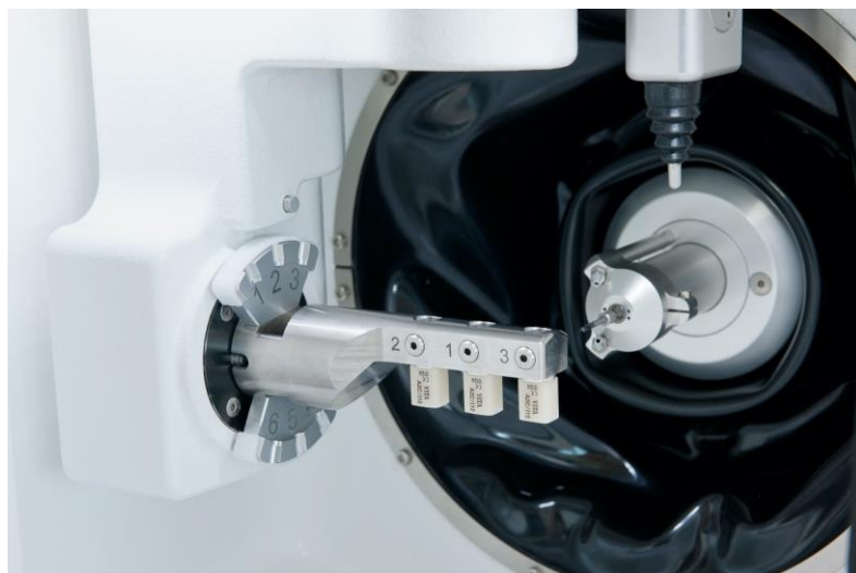
18. ábra CAM /számítógép vezérelt marás a megfelelő színű tömbből. (Borbély J, Hermann P. CAI – Digitális lenyomatvétel (Computer Aided Impressioning). In: Hermann P, Kispélyi B, eds. Fogpótlástan. Budapest: Semmelweis Kiadó; 2022.)
