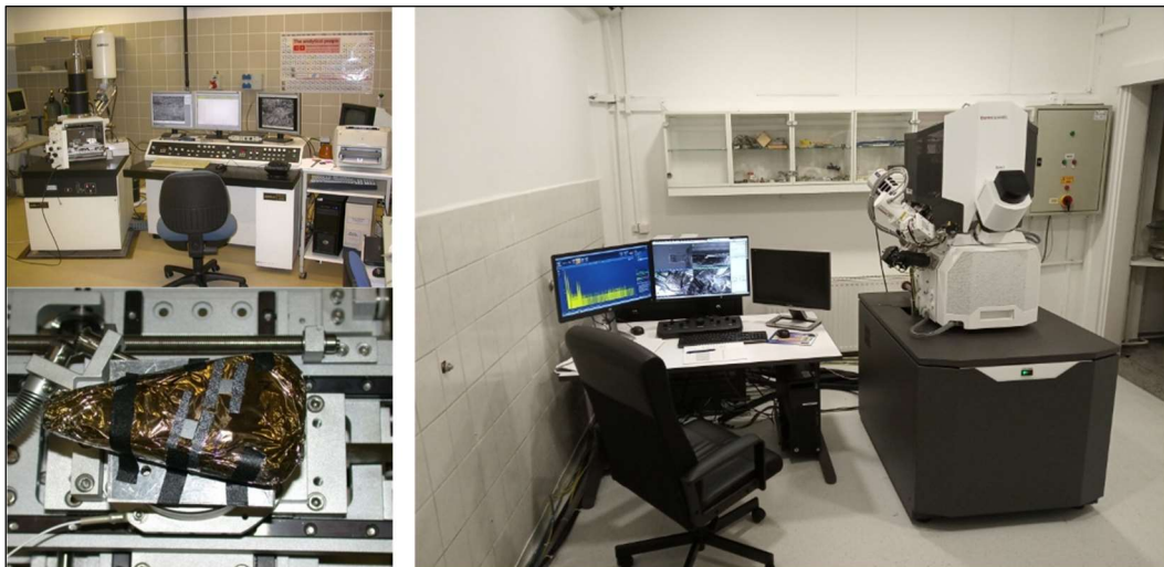
4.1.a-b. ábra. Az ELTE Kőzettan-Geokémiai Tanszék (a) és az Energiatudományi Kutatóközpont (b) nagyméretű tárgyak (kőbalták) vizsgálatára alkalmas SEM-EDX-készülékei. (Bendő et al. 2013)
