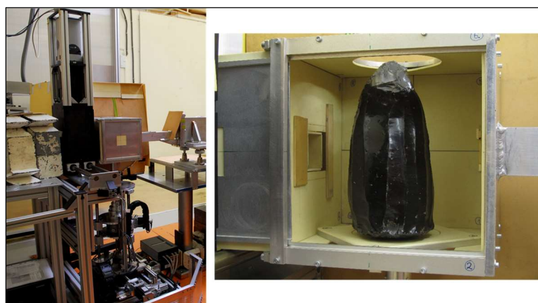
2.5.a-b. ábra. A Budapesti Neutron Centrum NIPS-NORMA-berendezése (a) és egy nagyméretű obszidián magkő a mintatartó kamrában (b).
