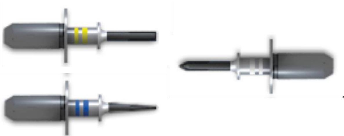
5-22. ábra: A PlanMill maró eszközei. A sárga csíkos hengeres (bal oldali felső kép) és a kék csíkos kónuszos (bal oldali alsó kép) a maró gép bal oldalába helyezve a korona belső felületét marják ki, „standard” illetve „detailed” beállítással. A fehér csíkos kúpos vagy torpedó végű szerszám a korona occlusalis felét alakítja ki és a jobb oldali orsóba van befogva. [Planmeca PlanMill kézikönyv]
