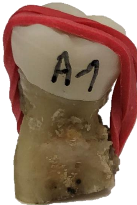
5-24. ábra: Az A1 kóddal rendelkező korona minta rögzítése az extrahált fagon gumiligatúrával a mikro-CT készülékbe történő behelyezés előtt. (Saját fotónk)
