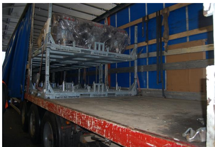
6.1. ábra. Autópárhban használatos összehajtható többutas speciális szállítóállvány
