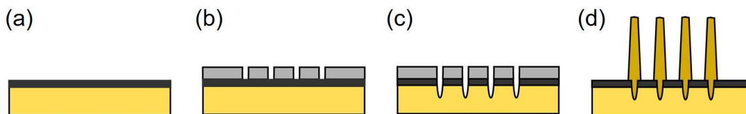
4.5. ábra. Területszelektív nedveskémiai növesztés keménymaszkon keresztül: fémréteg leválasztása (a); mintázat kialakítása EBL-lel (b); nukleációs ablakok átképzése a keménymaszkba ionmarással (c); nedveskémiai növesztés (d). A PMMA acetonos leoldása történhet a növesztés előtt vagy után
